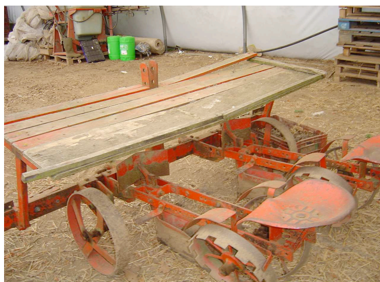
Planteuse polyvalente utilisable pour la plantation de pomme de terre (Possibilité d'y ajouter des roues à godet permettant un travail plus facile et plus régulier)
